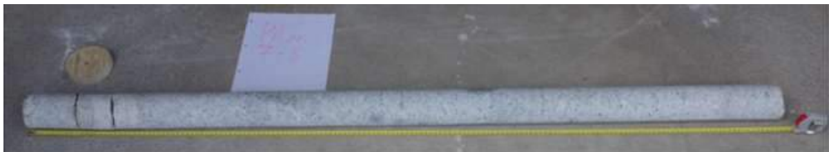
Eksempel på kjerneprøve, 158 cm lang. Bildet til høyre ovenfor viser prinsippet for hvor kjerneprøvene ble tatt.
