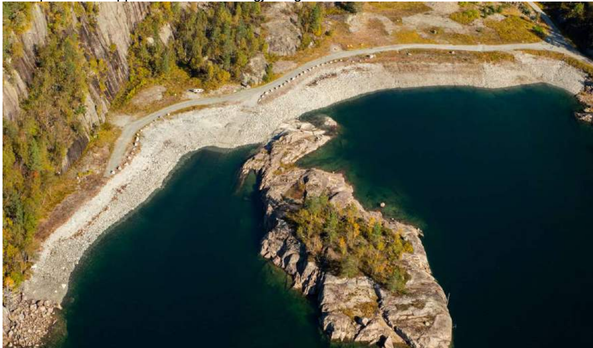
Tippen på Dalvatn, arrondert og tillaget etter uttak av masse til veibygging.
