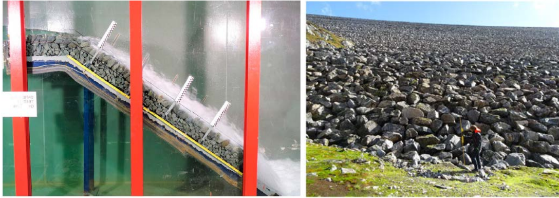
Figur 1. Venstre: eksperimentell plastringsmodell med tåstøtte, NTNU. Høyre: feltundersøkelse av plastringer på fyllingsdammer, Oddatjørndammen (Ravindra et al., 2019).
